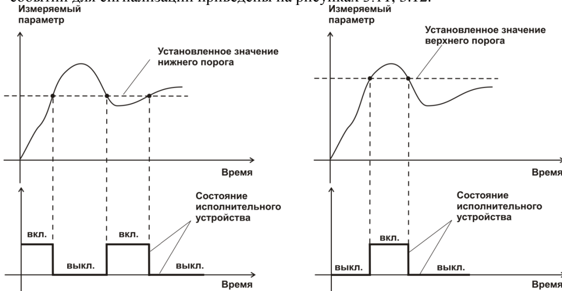
Рисунок 3.11 События: нарушения НП (слева), нарушение ВП (справа)
